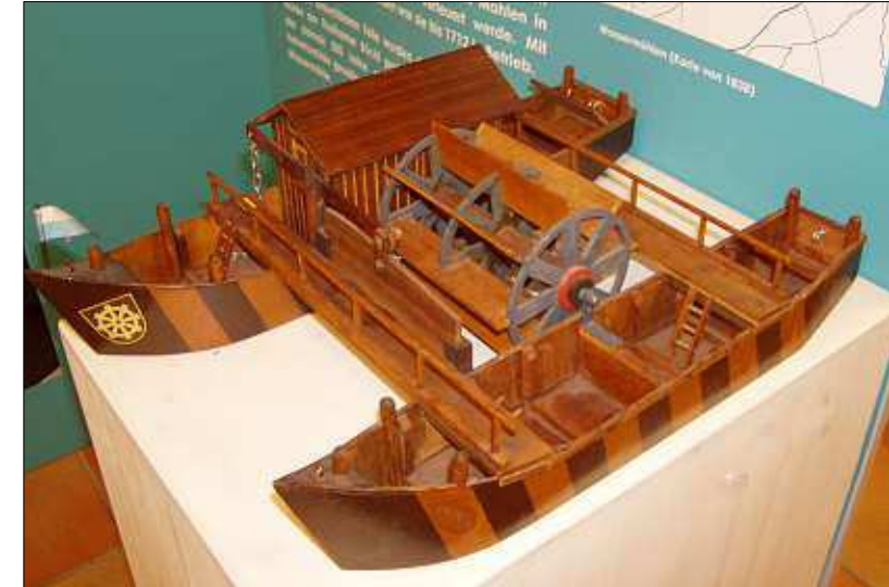
Interessant ist das Modell einer Schiffsmühle, zur Verfügung gestellt vom Innmuseum Rosenheim, wie sie einst überall im Inn standen mit dem „Hausschiff“ (Mühle, Mühlstube, Getreidekasten) und dem Weitschiff, Aufleger für das „Mühlgrindl“, die Achse des Mühlrades. – Foto: Diet
